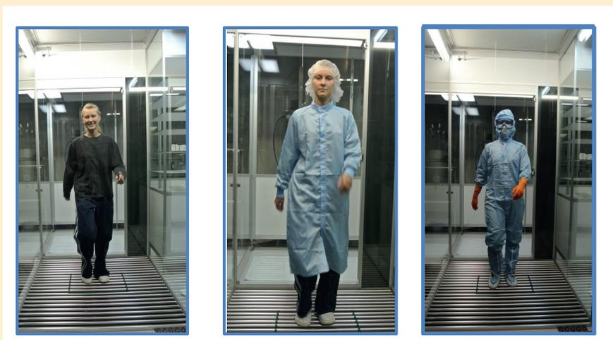
**Abb. 5:** Momentaufnahmen der Body-Box mit einer Person in unterschiedlichen Bekleidungssystemen
