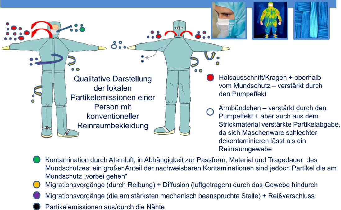
Abb. 7: Lokale Partikelemissionen einer Person mit konventioneller Reinraumkleidung
